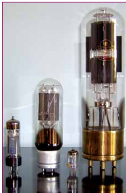
Foto 2: Confronto della T1610 (a destra) con altri tubi di potenza e di segnale impiegati comunemente nell'audio, dal quale si può capire meglio come il triodo in questione sia decisamente più grande degli altri, tale da farlo ritenere appartenente ad un'altra categoria. Nell'ordine da sinistra abbiamo una EL34, una 845 e una valvola di segnale noval.
