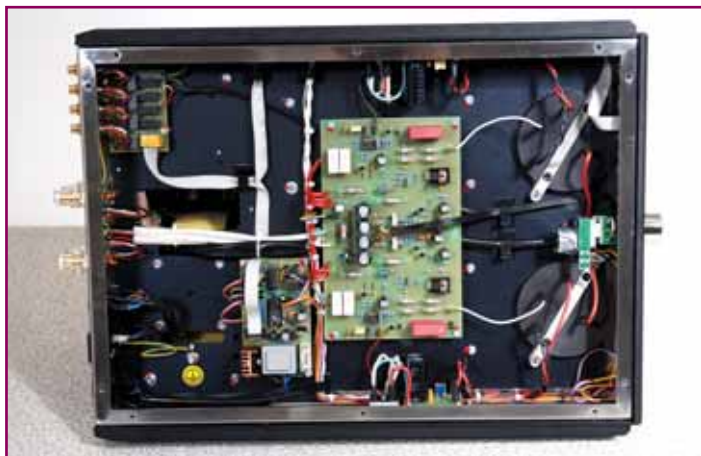
Foto 5: Interno dell'amplificatore. Si noti come la sezione di pilotaggio e amplificazione (circuito stampato al centro) sia realizzata facendo ricorso, per precisa scelta progettuale, solo a pochi componenti a stato solido. Elevata la qualità della componentistica utilizzata.
