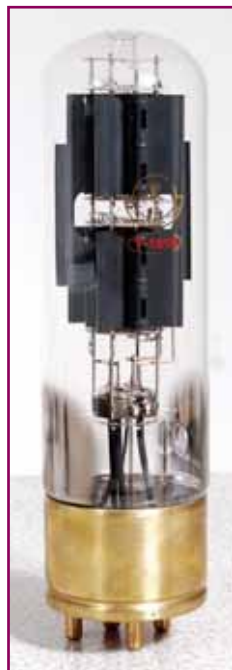
Foto 1: Primo piano del Triodo a riscaldamento diretto T1610 da cui si può intuire l'elevatissimo livello realizzativo.
